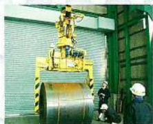
吊具全体の動作確認
