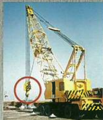
移動式クレーン用65t回転フック For Wheel Crane
