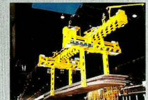
8t電動式シートリフター 8-ton Electric Sheet Lifter
