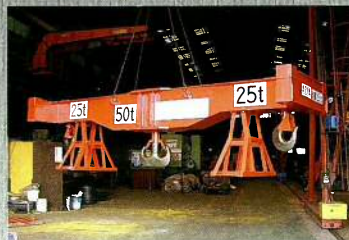
50tコンテナスプレッダー用吊ビーム 50-ton Lifting Beam
