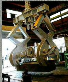
26tチタンインゴットトンク 26-ton Titanium Ingot Tong
