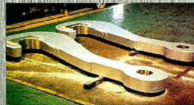
380tラミネーションフック 380-ton Lamination Hook
