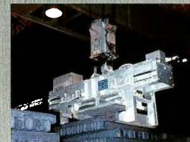
10t電動式ビレットリフター 10-ton Electric Billet Lifter
