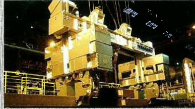
14tスラブトンク (常温~1000℃) 14-ton Electric Slab Tong
