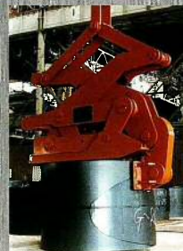
26t竖吊コイルトンク 26-ton Vertical Coil Tong
