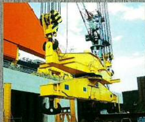
700t旋回ビーム 700-ton Rotating Lifting Beam
