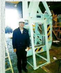
29.2tC型フック (スプリング=ウェイト式) 29.2-ton "C" Hook (Spring & Weight Type)
