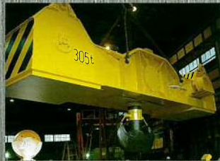
305t回転フック 305 ton Electric Revolving Hook Block
