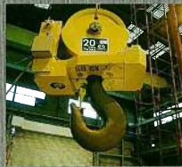
ホイスト用回転フック For Hoist Crane
