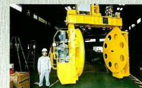
コンベアベルト巻取装置 3-ton Winding Conveyor Belt Equipment
