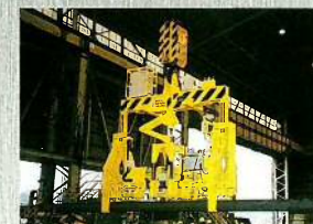
20t機械式スラブリフター 20-ton Mechanical Slab Lifter
