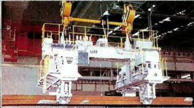
45tスラブトンク (常温~900℃) 45-ton Electric Slab Tong
