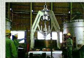
2.5t機械式アップエンドコイルリフター 2.5-ton Mechanical Upendcoil Lifter
