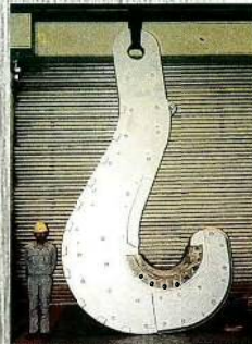
430tラミネーションフック (フックメタル付) 430-ton Lamination Hook
