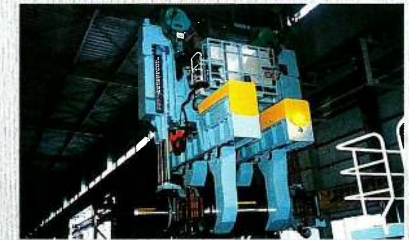
101.8t電動式バックアップロールリフター 101.8-ton Electric Backuproll Lifter
