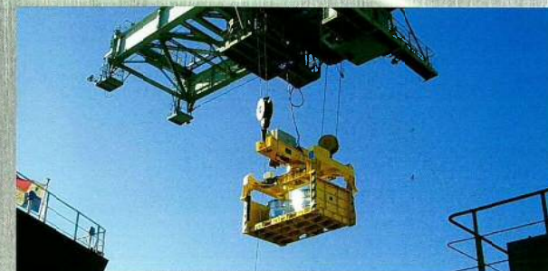
26.5tコンテナスプレッダー 26.5-ton Container Spreader
