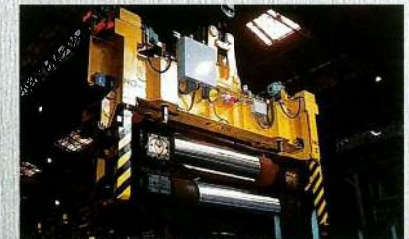
36t電動式ワークロールリフター 36-ton Electric Workroll Lifter
