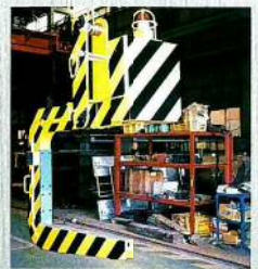
27.3tC型フック光電センサー付 27.3-ton "C" Hook With Bore Sensor
