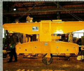
31t旋回ビーム 31-ton Rotating Beam
