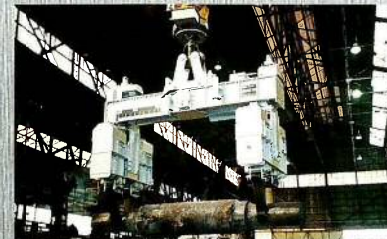
10t電動式ワークロールリフター 10-ton Electric Workroll Lifter
