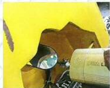
吊具内部溶接状態の確認
