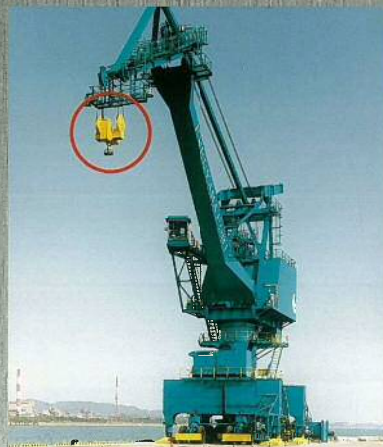
ダイヤモンド式水平引込クレーン用34.5t回転フック For Rubber Tired Level Lifting Jib Crane
