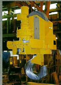
原子力発電所向け25t回転フック (フック及びシープSUS使用) For Nuclear Power Plant
