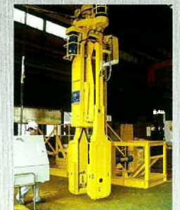
27tリンク式旋回CL 27-ton Link Type
