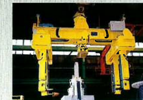
15tアップエンドコイル兼用2ヶ吊CL For Upend and Downend Coil
